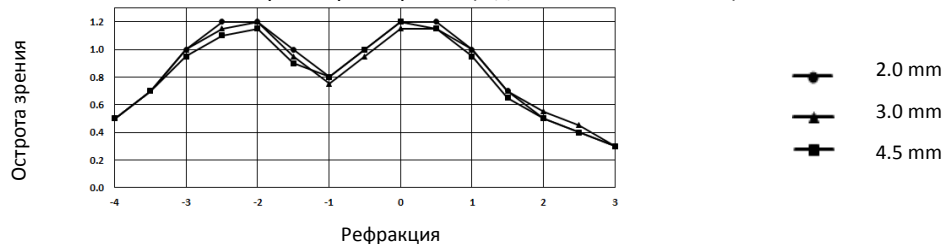
График 2: Кривая средней расфокусировки дифракционных прогрессирующих ИОЛ MediconTur в соответствии с размером зрачка (с добавлением + 3,5 D)
